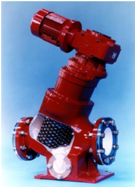
«Высокомоментная низкоскоростная дробилка для трубопроводов, подходит для эффективного разложения выбросов и абразивных шламов. Основные характеристики: отсутствие нижних подшипников и уплотнений, встроенная ловушка, отводящаяся вставка резца».
